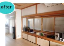
【断熱工事】 内障子を外して樹脂製の内窓を設置 夏涼し〈冬は暖か〈、結露の不快も解消
